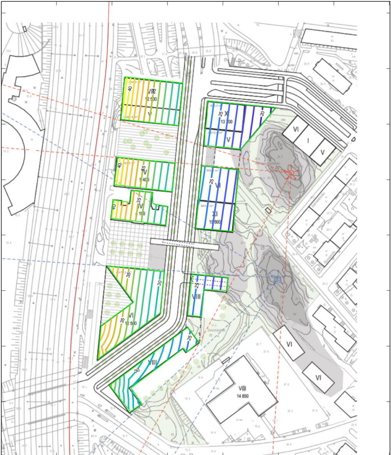
Kuva D1: Mittauksista arvioidut runkomelutasot rakennusten alimmissa kerroksissa. Taustalla kehitysehdotuksen massoitteluvaihtoehto.
