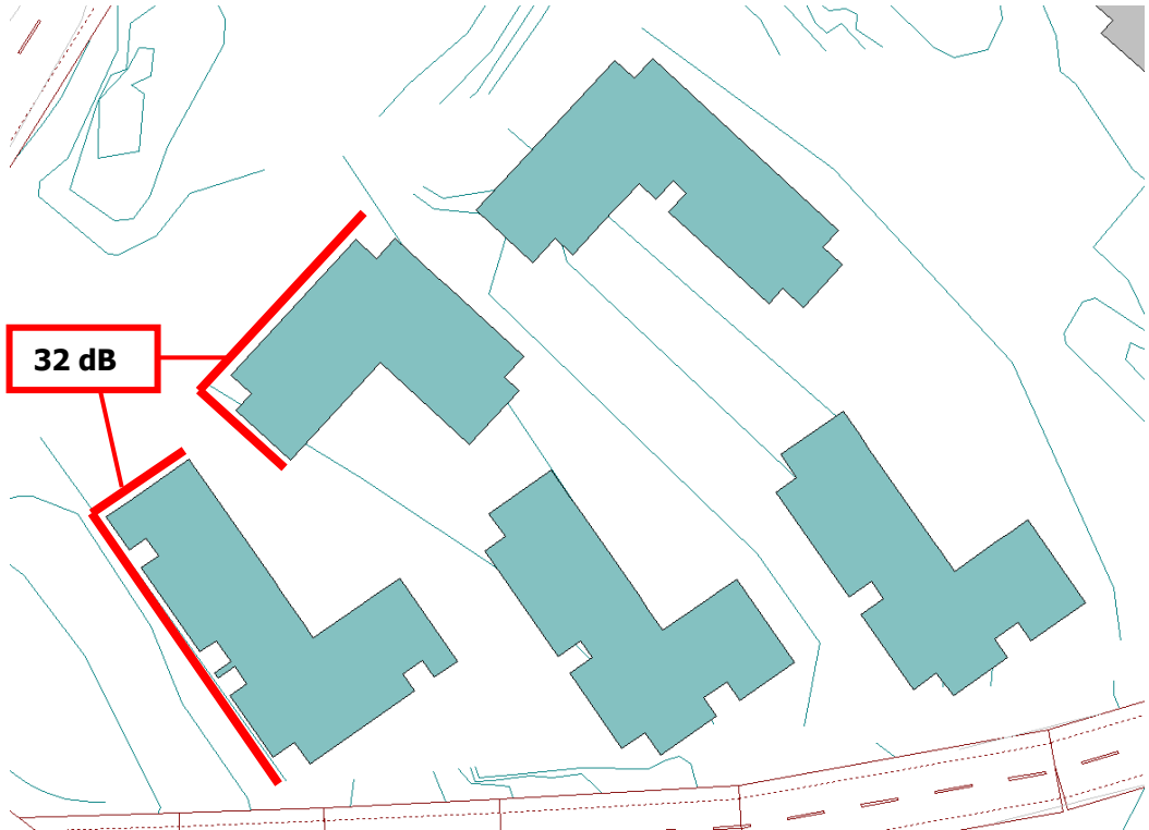
Kuva 2. Melumallinnuksen mukaiset ulkovaipan äänitasoerovaatimukset.
