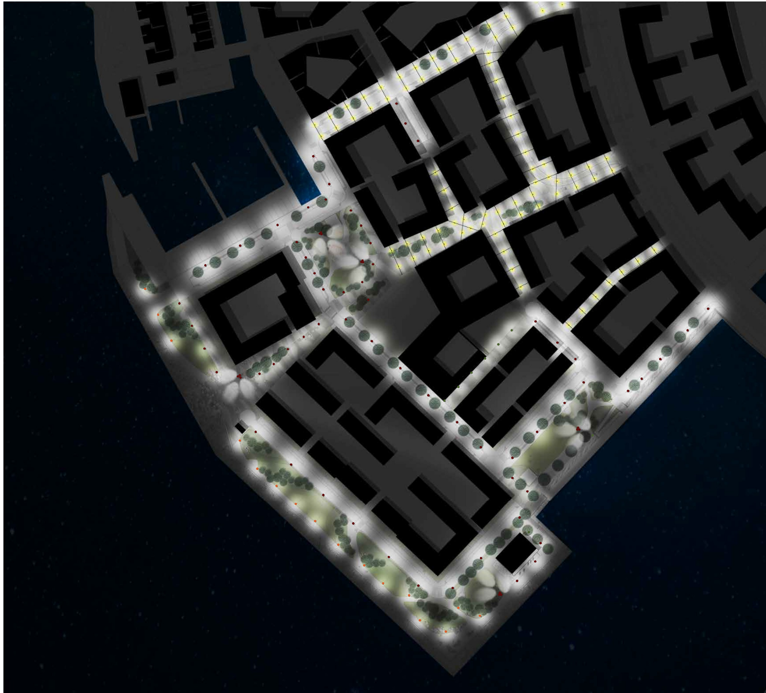
Saukonlaiturin valaistuksen ripustus- ja pylväsvalaistuksen periaate (WSP).
