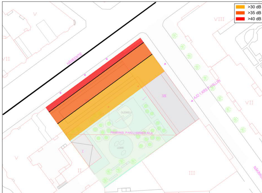
Kuva 5: Mittaustuloksiin perustuva runkomelun leviämismallinnus kohteen 2. kerroksessa. Tärinää
