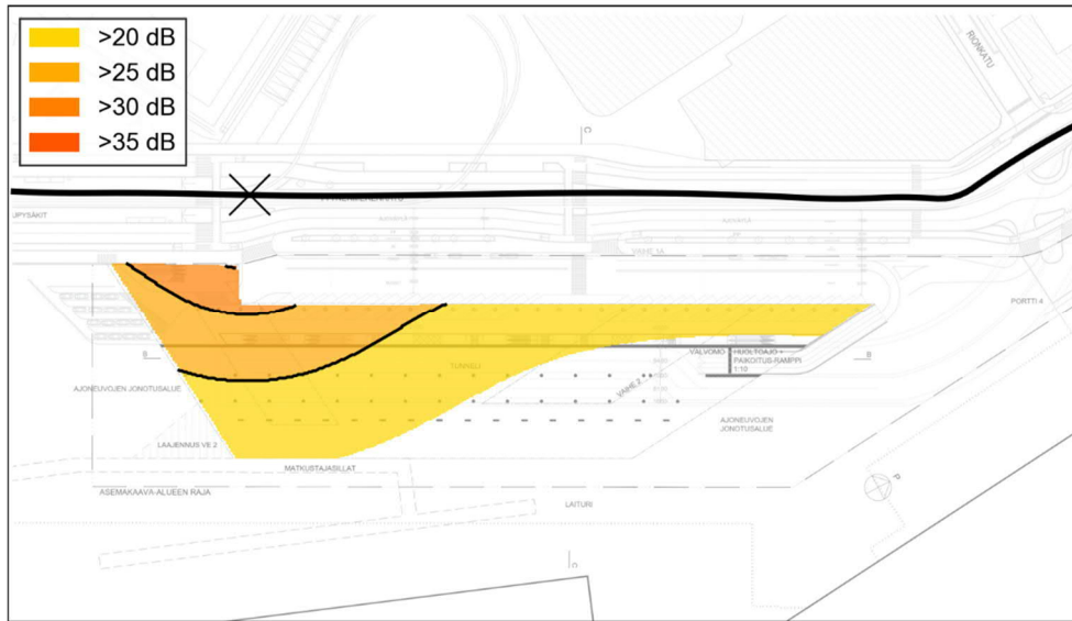
Kuva 4: Läntiselle raiteelle lasketut runkomelualueet esitettynä asemapiirroksessa rakennuksen alimman varsinaisen kerroksen osalta. Kuvassa on esitetty alueet, jossa sisätiloissa esiintyvä runkomelu ylittää mallinnuksen perusteella 20 dB tason. Lähin vaihde on merkitty rastilla.
