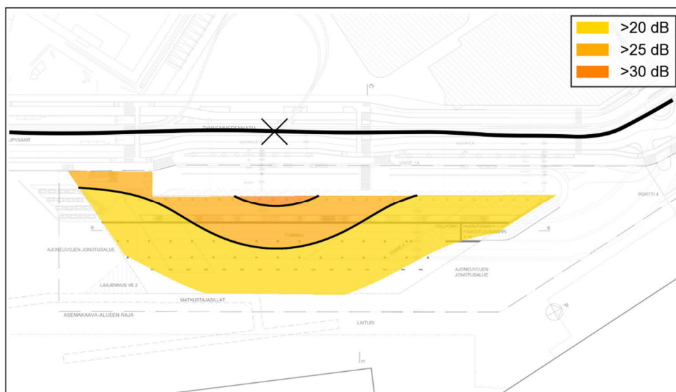
Kuva 3: Itäiselle raiteelle lasketut runkomelualueet esitettynä asemapiirroksessa rakennuksen alimman varsinaisen kerroksen osalta. Kuvassa on esitetty alueet, jossa sisätiloissa esiintyvä runkomelu ylittää mallinnuksen perusteella 20 dB tason. Lähin vaihde on merkitty rastilla.
