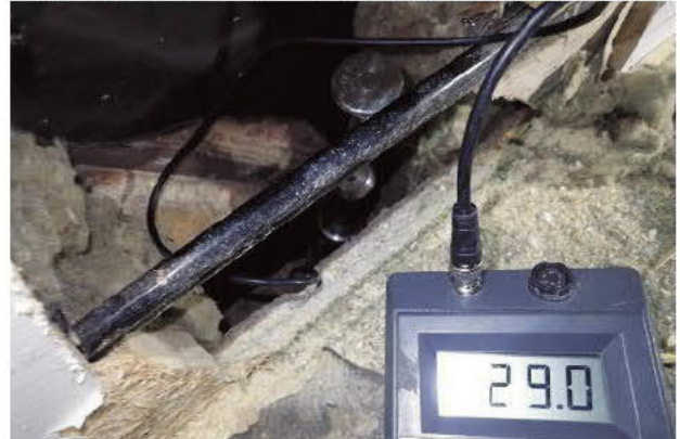
Kuva 18. Alajuoksun yläpinta on kostea, painoprosentit 29 (raja-arvo on 18).
