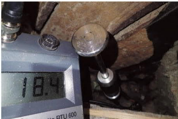
Kuva 13. Alajuoksun yläpinta on kostea, painoprosentit 18,4 (raja-arvo on 18).
