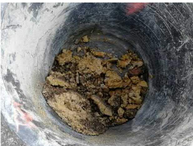
Kuva 5. Pisteessä VAH3 kirjavaa hiekkaa syvyydellä 0,5-1 m.
