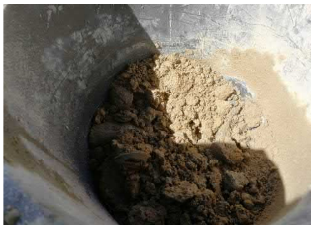
Kuva 6. Pisteessä VAH9 hienoa hiekkaa syvyydellä 2-2,3 m.
