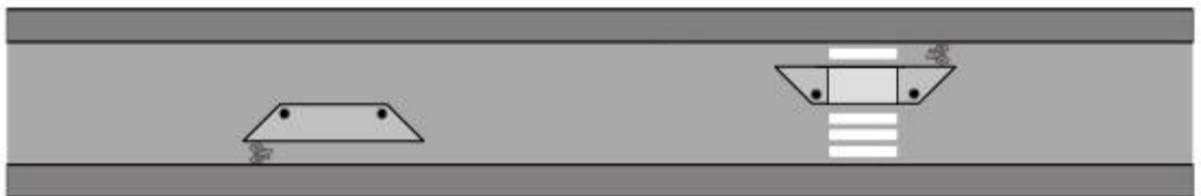
Kuva 21. Kavennus ja sivuttaissiirtymä (mutkahidaste) suojatien yhteydessä.
