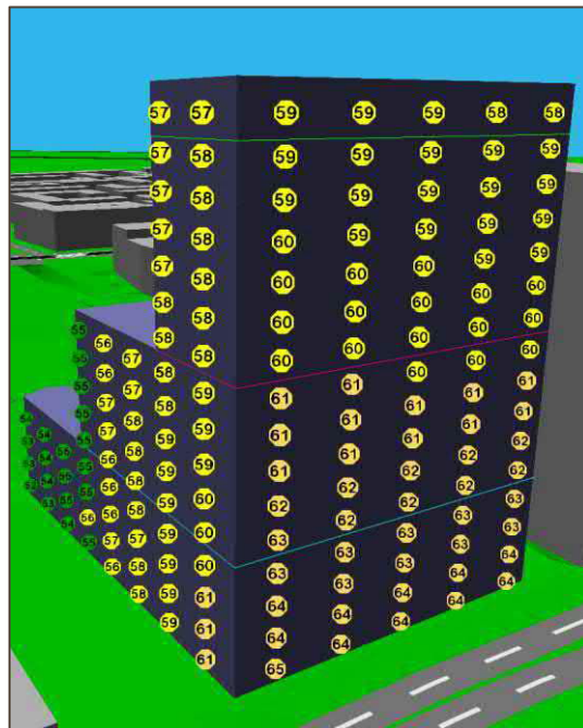
Kuva 8. Tie- ja raideliikenteestä aiheutuvat päiväajan keskiäänitasot L_{A,eq7-22} toimisto-, liiketila- ja hotellikerrosten julkisivulla
