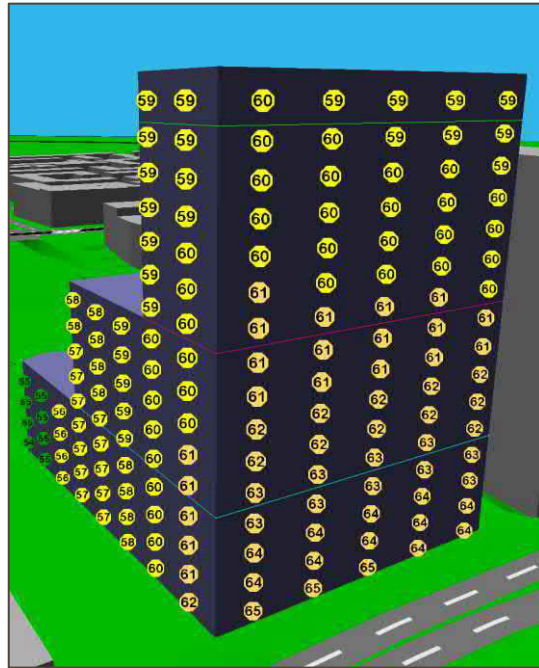
Kuva 21. Yhteismelusta aiheutuvat päiväajan keskiäänitasot L_{A,eq7-22} rakennuksen julkisivulla
