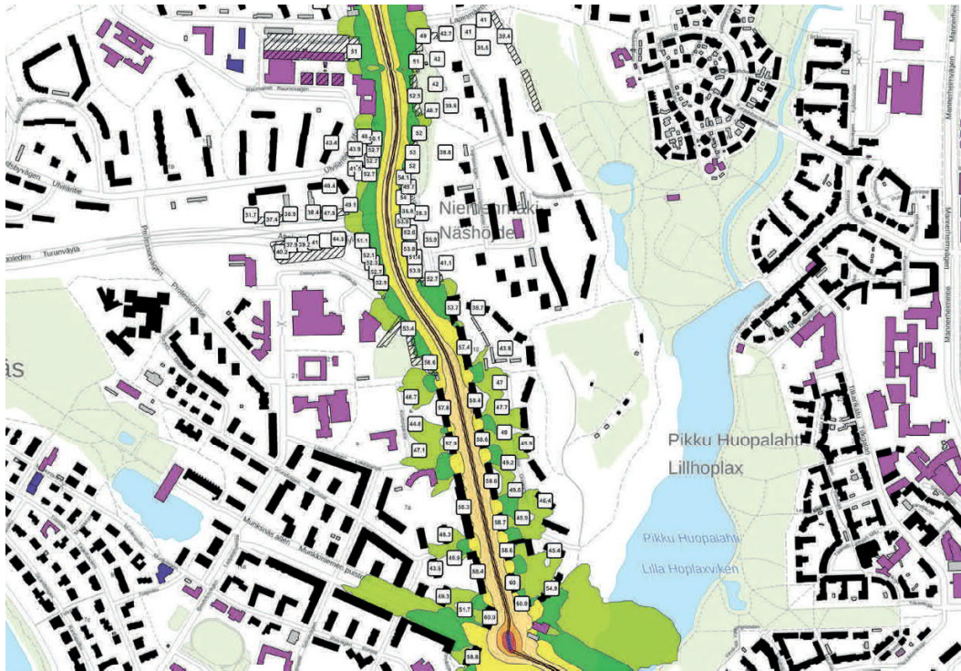
Kuva 52: Asuinrakennusten julkisivuihin kohdistuvat keskiäänitasot Huopalahdentien alueella ennustetilanteessa päivällä klo 7–22. Kuvan keltainen vyöhyke kuvaa VNp 993/1992 mukaisen päiväajan ohjearvon rajaa. Kartan lähde: Maanmittauslaitos
