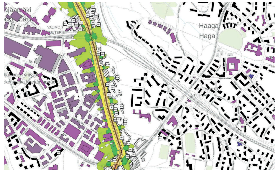
Kuva 51: Asuinrakennusten julkisivuihin kohdistuvat keskiäänitasot Vihdintien alueella ennustetilanteessa päivällä klo 7–22. Kuvan keltainen vyöhyke kuvaa VNP 993/1992 mukaisen päiväajan ohjearvon rajaa Lähde: Maanmittauslaitos
