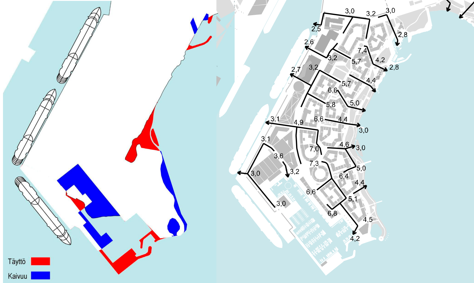
Täytöt ja kaivut
