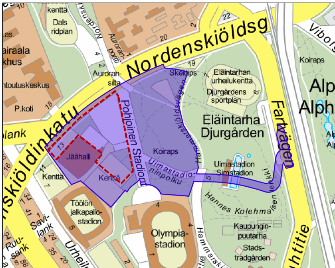
Kuva 2. Helsinki Garden hankkeen tilavarauskavio (violetti väri, kartta Helsingin kaupungin karttapalvelu). Punaisella katkoviivalla merkitty viitteellinen maanpäällinen suunnittelualue, muu alue on maanalaista tilavarausta.
