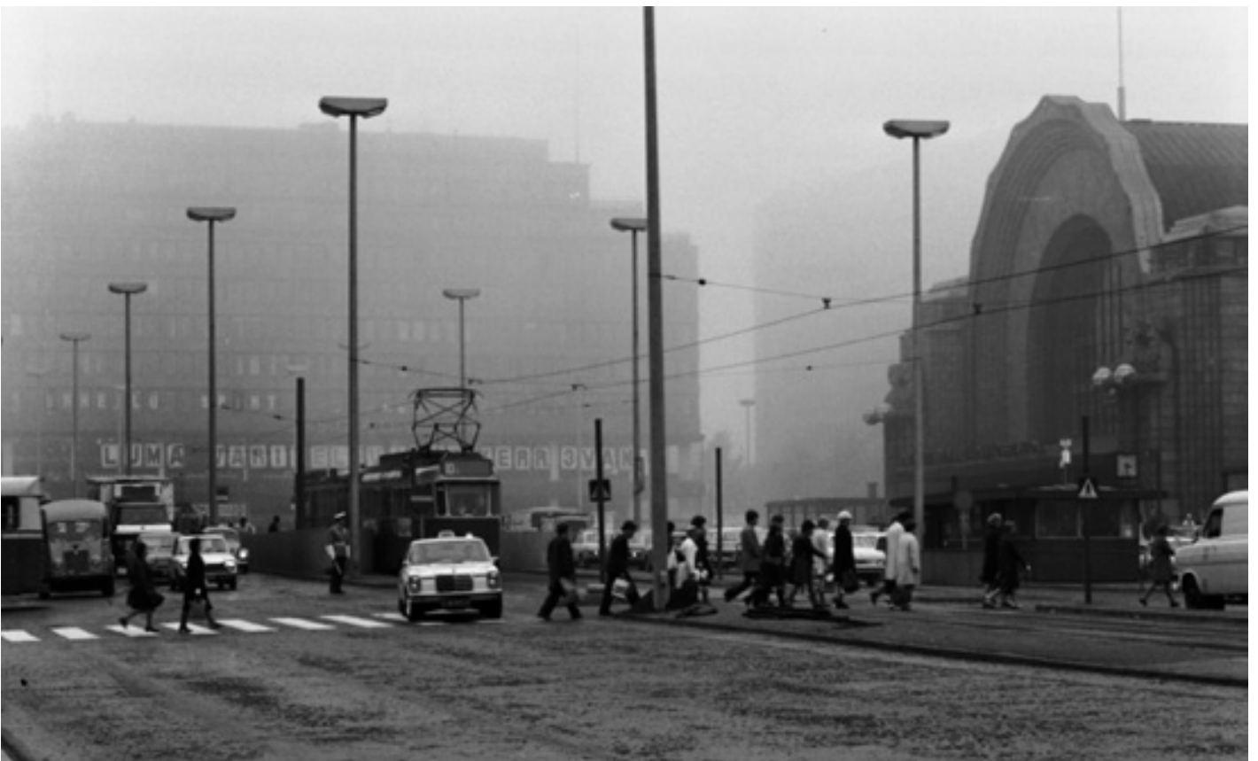
1969 asennetut uudet laatikkomaiset pylväsvalaisimet. Mittakaavaltaan raskaista valaisimista tuli maisemaa hallitseva elementti. Osittain samat valaisimrungot ovat edelleen käytössä Kaivokadulla. Eeva Rista, HKM.
