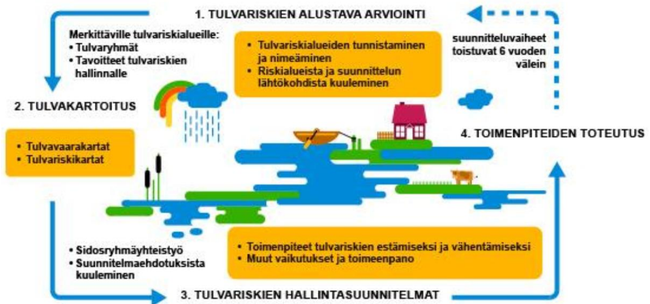
Kuva 2.1-1. Vesistö- ja merivesitulvariskiä hallinnan suunnittelun vaiheet.
