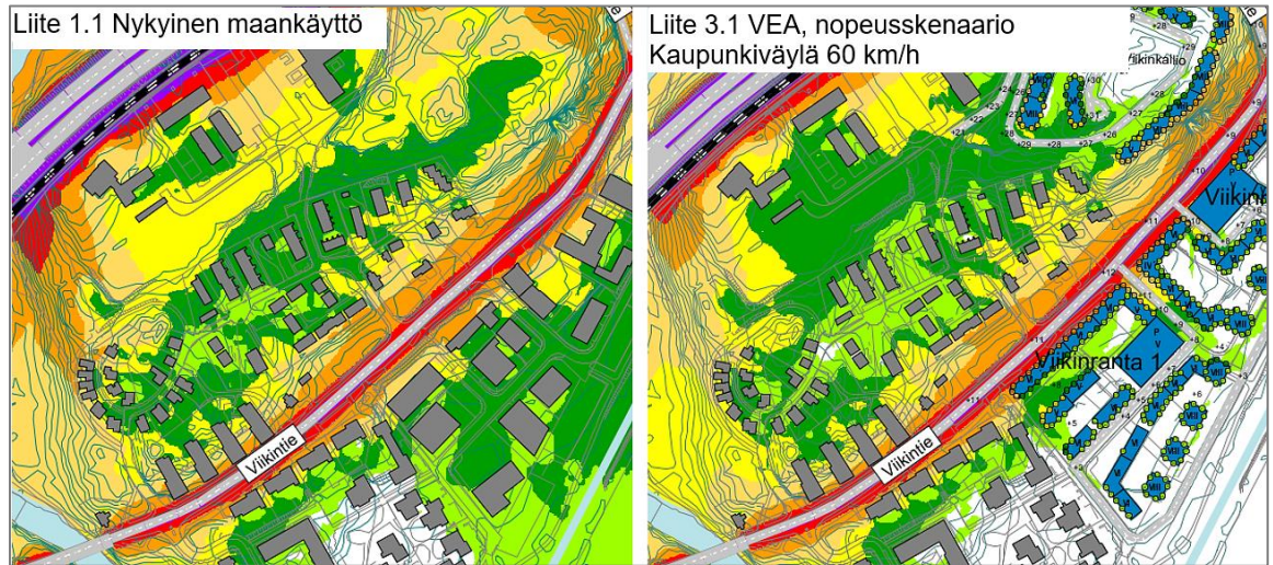
Kuva 9 Viikinrannan nykyisen asuinalueen päivääjan keskiäänitaso nykyisellä maankäytöllä (vasemmalla) ja ennustevaihtoehdolla VEA Lahdenväylän nopeusskenaariolla Kaupunkiväylä 60 km/h (oikealla). Kuva on ote liitteistä 1.1 ja 3.1.
