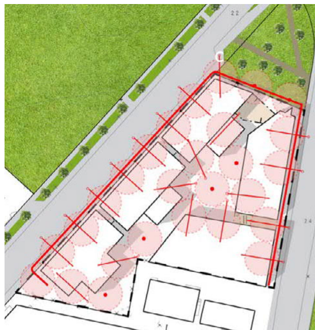
Kuva 19. Maalämpöjärjestelmän osien sijoittaminen Vattuniemen korttelissa 31114.
