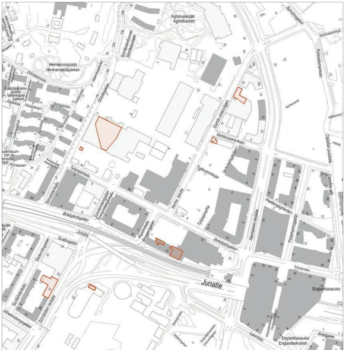
Kuva 6.1 Puupaaluperusteiset rakennukset tunnelin lähialueella (punaisella). Lähde: karta.hel.fi, aineisto: puupaaluperusteiset rakennukset (viitattu 12.6.2020). ( https://karta.hel.fi/link/8NJfY9 , )
