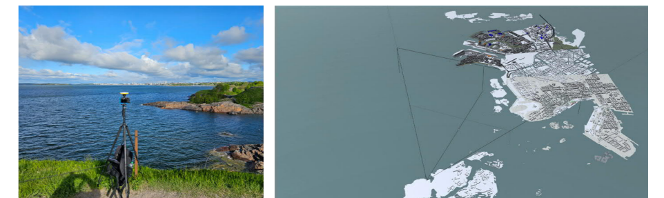
▲ Valokuva näköalapaikasta ja kalibrointi GNSS-vastaanottimella.
