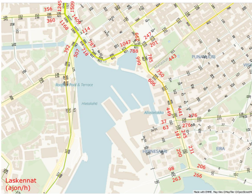
Kuva 2. Iltahuipputunnin liikennemäärät mallin nykytilassa (2022) ja laskennoissa 2013-2021.
