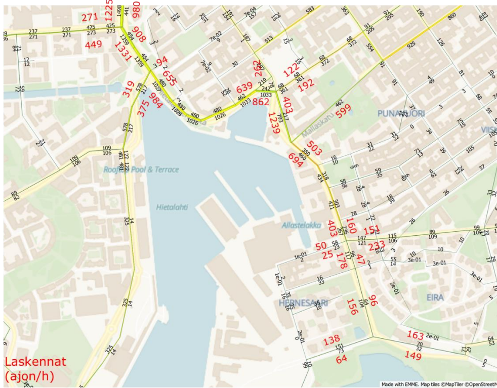
Kuva 1. Aamuhuipputunnin liikennemäärät mallin nykytilassa (2022) ja laskennoissa 2013-2021.
