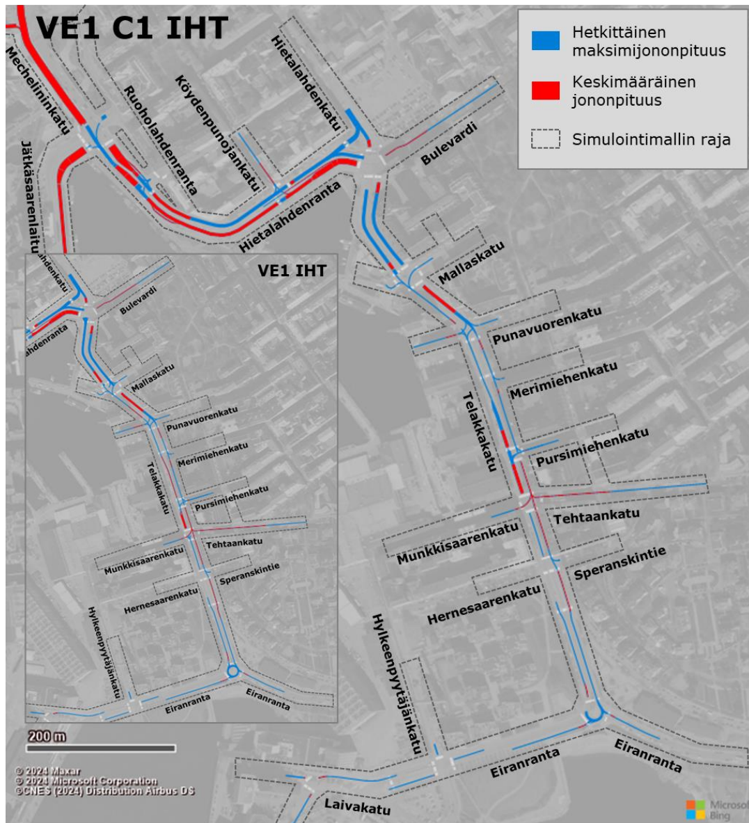
Kuva 16. Iltahuipputuntin hetkittäiset maksimijononpituudet sekä keskimääräiset jononpituudet VE1 C1 herkkyytarkastelutilanteessa.
