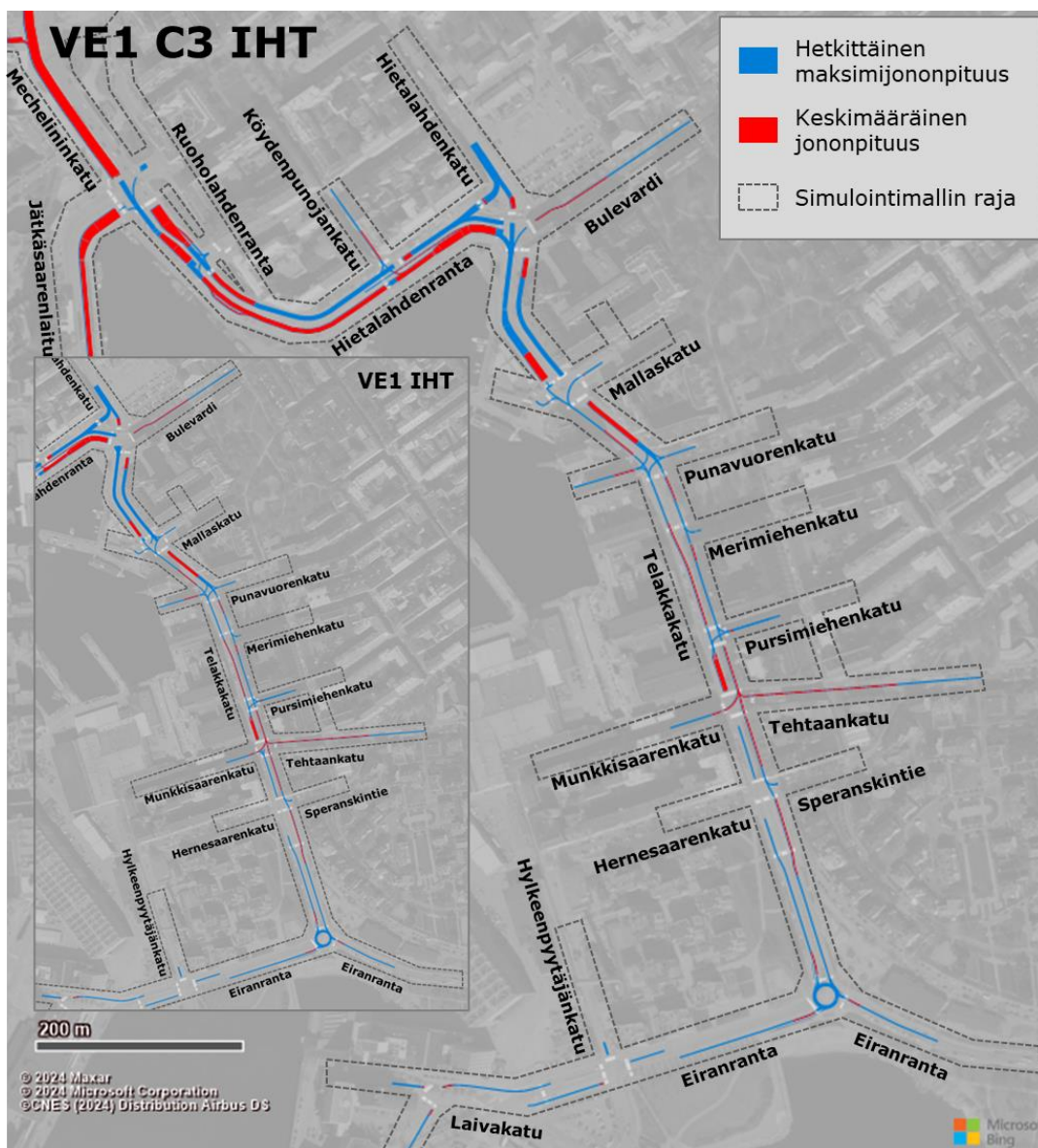
Kuva 18. Iltahuipputuntin hetkittäiset maksimijonopituudet sekä keskimääräiset jonopituudet VE1 C3 herkkyytarkastelutilanteessa.
