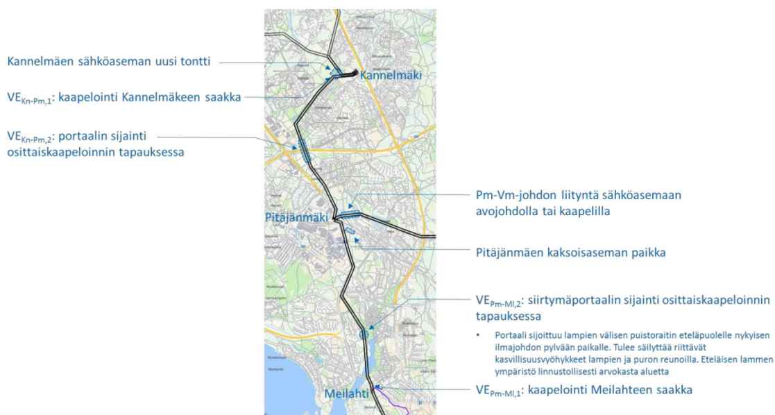
Kuva 5. 110 kV johtojen kaapelointiin ja Pitäjänmäen sähköaseman siirtoon käytettävät alueet
