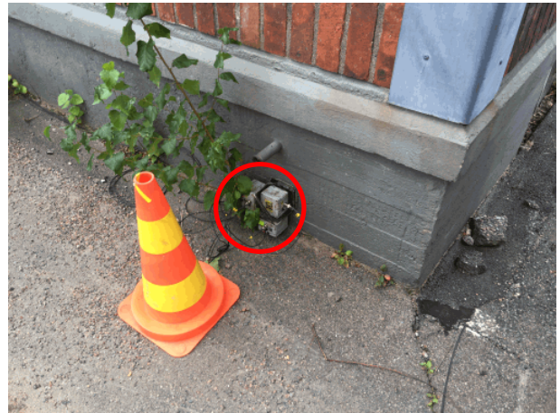
Mittauspiste 9. Sijainti vanhan pienteollisuusrakennuksen kadunpuoleisella pohjoiskulmalla. Anturien kiinnitys liimaamalla rakennuksen betonisokkeliin.
