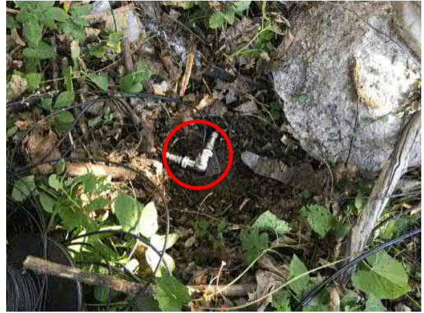
Mittauspiste 2. Sijainti purku-urakka-alueen raja-aidan vieressä, kuormalavojen varastoalueen pohjoisreunassa olevan maavallin takana. Anturien kiinnitys maaruuvin varaan.
