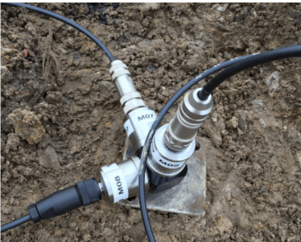
Mittauspisteet 6 ja 7. Anturien kiinnitys maaruuvilla.
