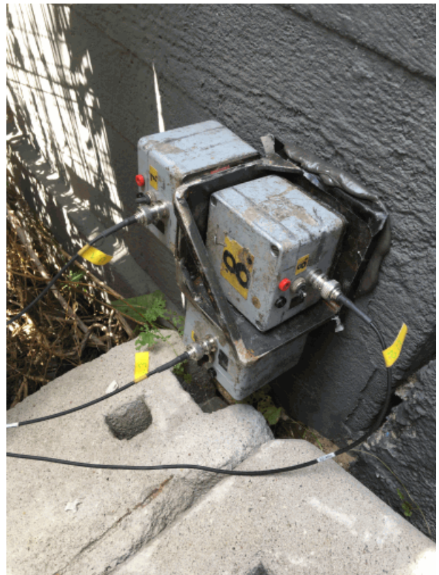
Mittauspiste 8. Sijainti vanhan pienteollisuusrakennuksen radanpuoleisella pohjoiskulmalla. Anturien kiinnitys liimaamalla rakennuksen betonisokkeliin.
