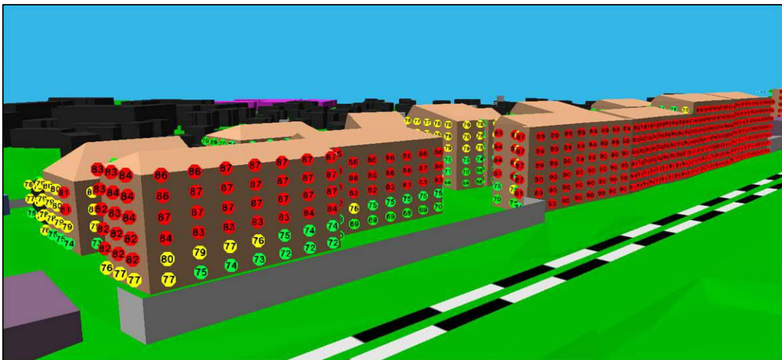
Kuva 15 Viertolantie 6 ja Malmin kauppatie 43 julkisivuihin kohdistuvat junaliikenteen enimmäisäänitasot L_{Amax} .
