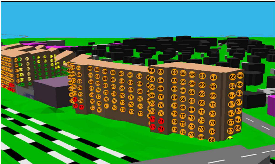
Kuva 4 Julkisivuihin kohdistuvat päiväajan melutasot ennustetilanteessa. Viertolantie 2, kaava-alueen pohjoisosassa melutaso suurimmillaan radan puolella 71 dB.
