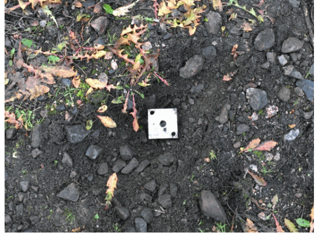
Mittauspiste 4. Sijainti purkutyömaan alueella radan puolella. Anturien kiinnitys maaruuvilla.
