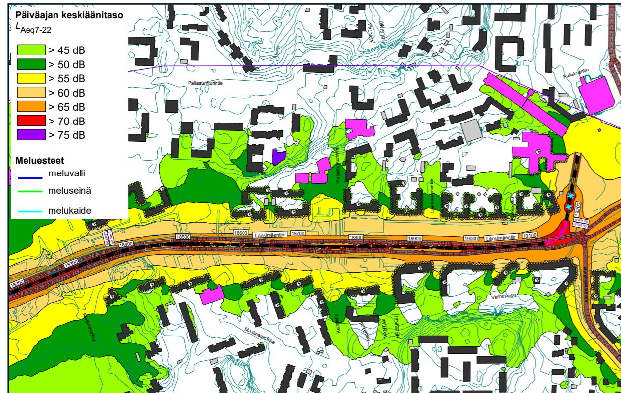
Kuva 8. Vantaan ratikan yhteismelutilanne, suunniteltu meluntorjunta ja päiväajan keskiäänitaso. (Lähde: Sitowise 2023)
