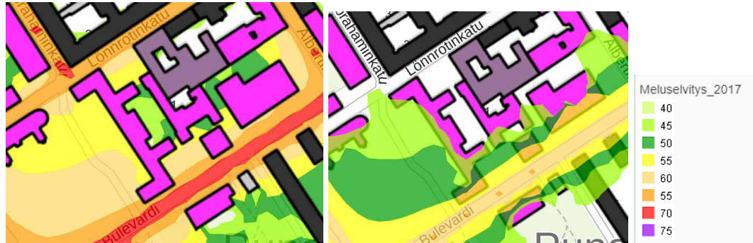
Kuva 3. Vasemmalla katuliikenteen päiväajan keskiäänitaso L_{Aeq7-22} laskentakorkeudella mp+2m , oikealla raitiotieliikenteen vastaava keskiäänitaso L_{Aeq7-22} .
