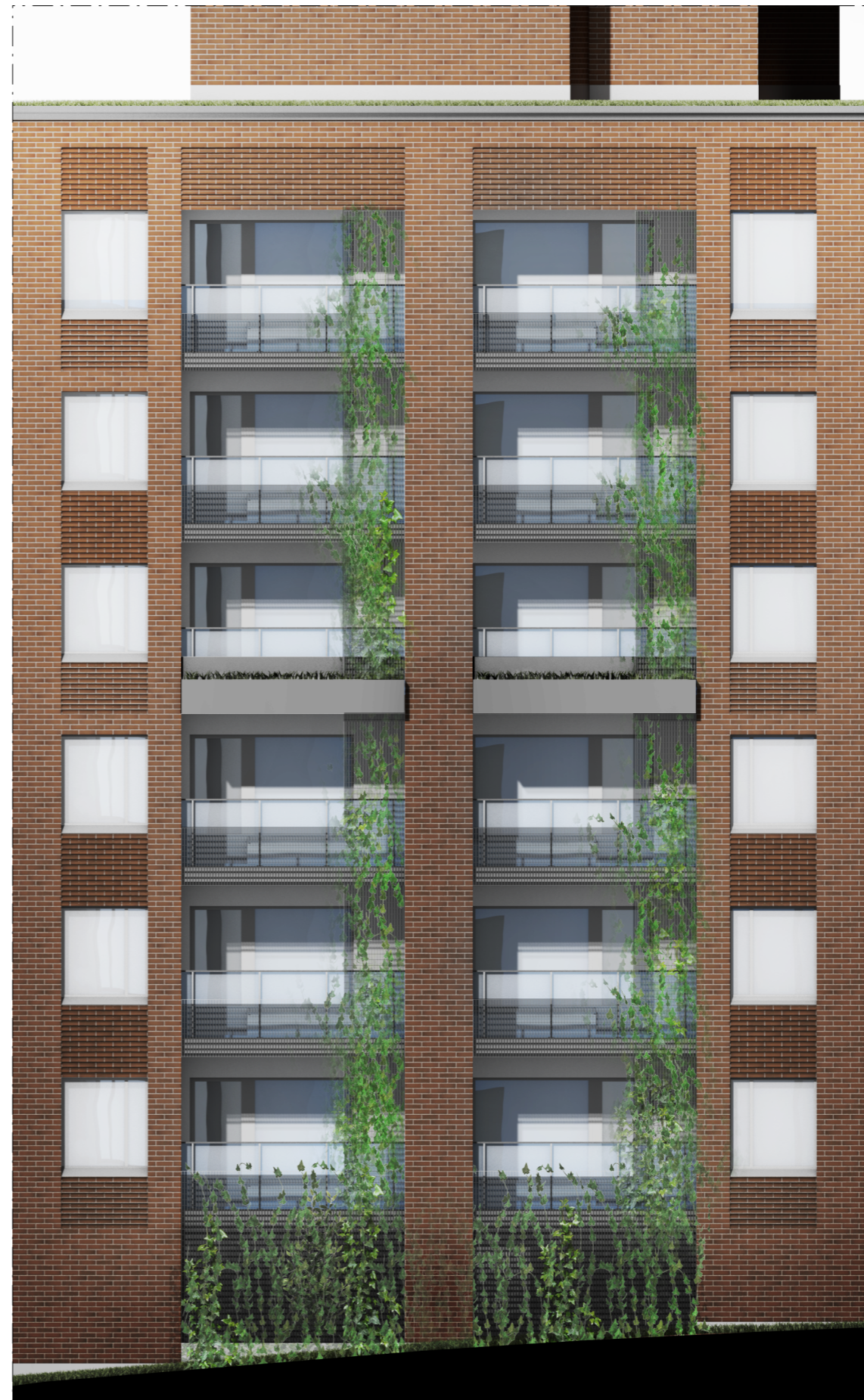
JULKISIVUOTE POHJOISEN HÖYRYPOLULLE 1/100 : VIHERSEINÄ
