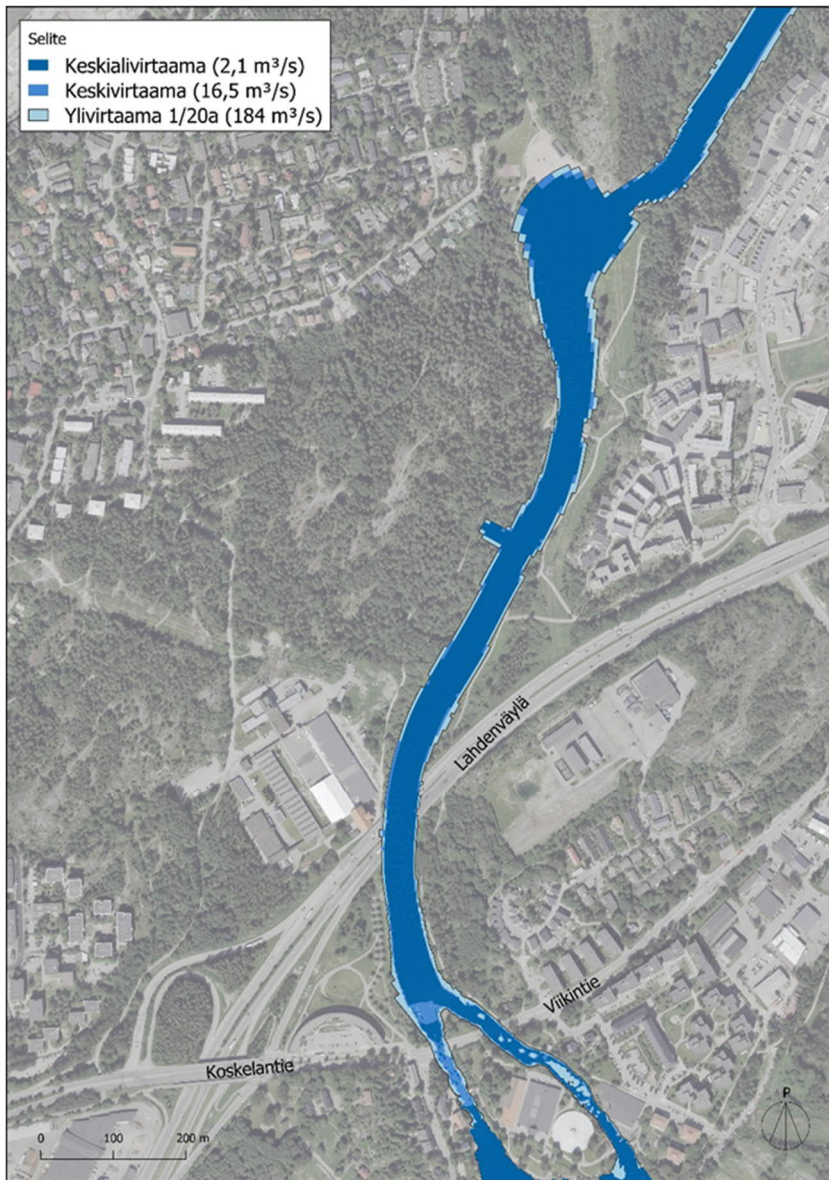
Kuva 29 Simuloidut vedenkorkeudet skenaariossa 3 Vanhankaupunginkosken Pikkukosken uima- rannan välillä (keski- ja ylivirtaama).
