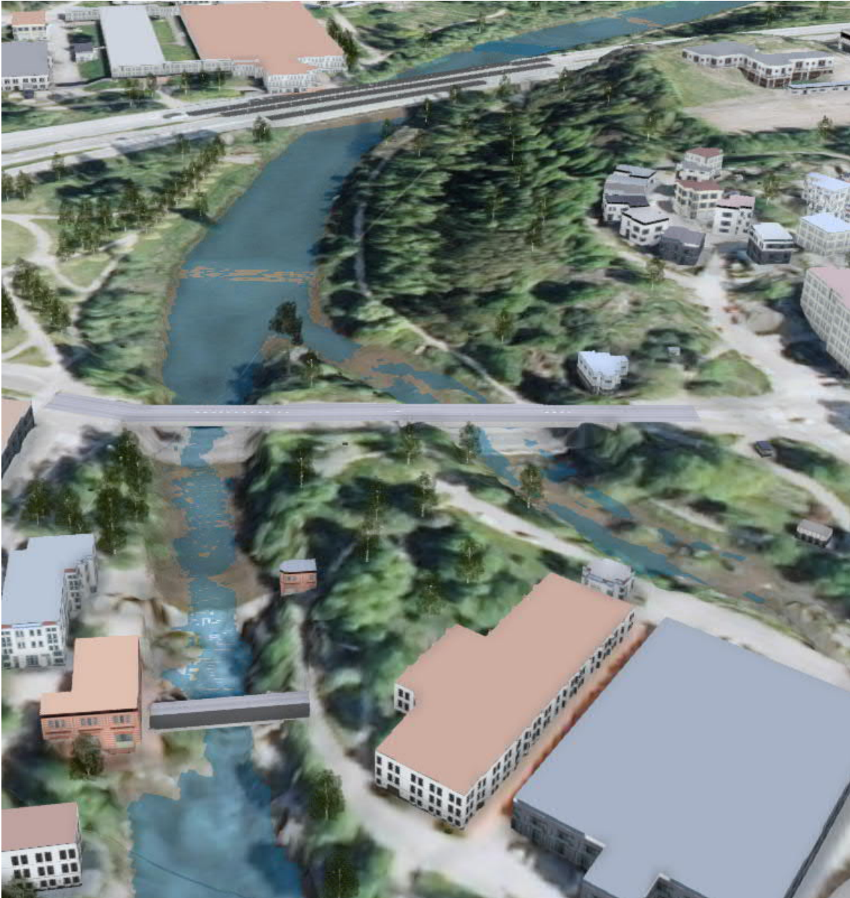
Kuva 32 Skenaarioiden 4 havainnekuva Vanhankaupunginkosken padon kohdalta pohjoisen suuntaan. Simuloitu keskialivirtaaman aikainen vedenpinta. Havainnekuva laadittu Autodeskin InfraWorks-ohjelmistossa.
