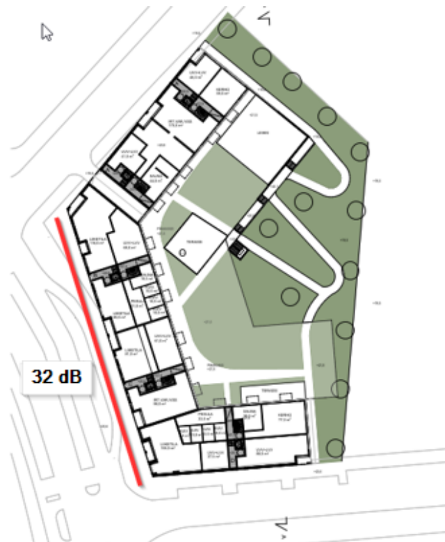
Kuva 2. Kuvassa on esitetty tie- ja raitiliikenteestä keskiäänitasoista rakennuksen julkisivuille muodostuvat 30 dB tai sen ylittävät ulkovaipan äänitasoero-vaatimukset \Delta L_{A,vaad} .
