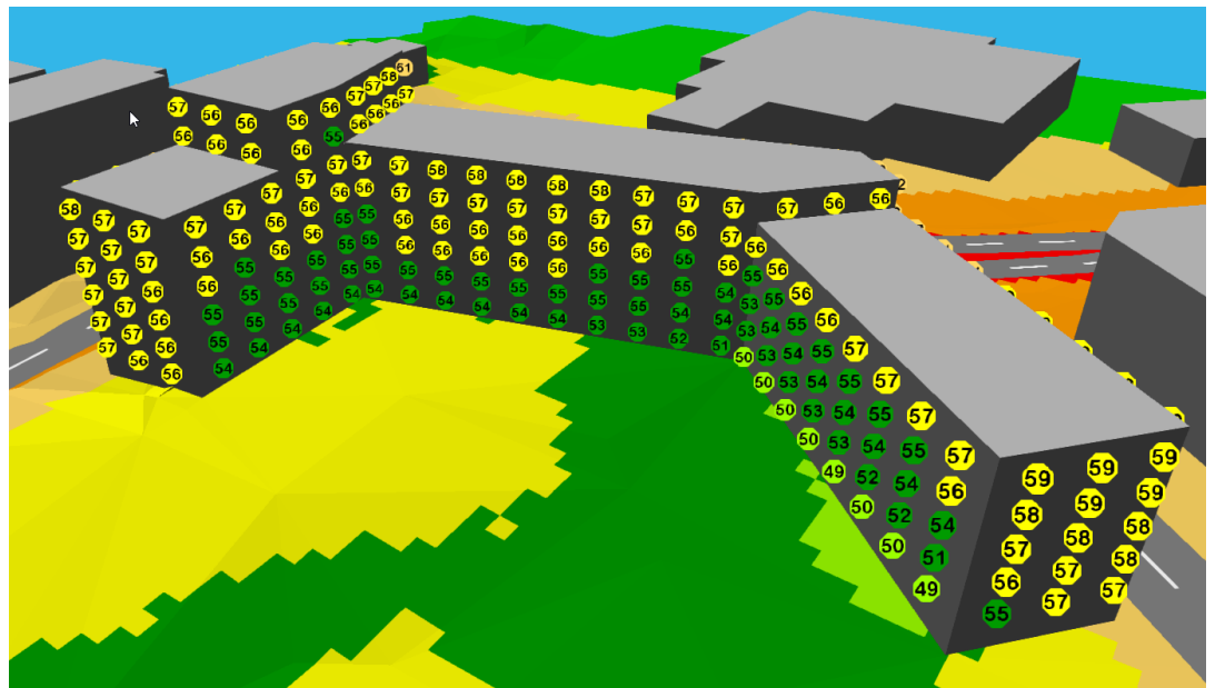
Kuva 5. Tie- ja raiteliikenteestä aiheutuvat päiväajan L_{A,eq7-22} suurimmat keskiäänitasot rakennuksen julkisivulla 3D-näkymässä. Asunnot sijaitsevat toisesta kerroksesta ylöspäin.
