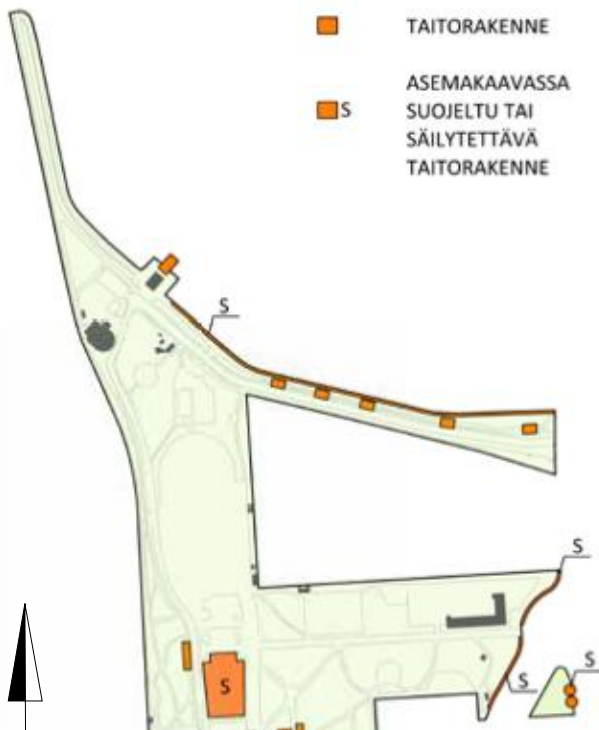
Kohteen taitorakenteet. Osa taitorakenteista on suojeltu asemakaavalla, kuten vesiallas, Kaisaniemenkadun vastaiset muurit ja Varsapuistikot porttinpylväät. Myös Kaisaniemenlahden vastainen rantamuuri on suojeltu. Muita puiston rakenteita ovat laiturit, portaikot ja tukimuurit.
