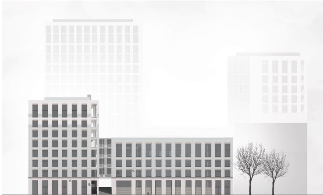
1. PAIKALLAMURATTU TIILI, KOLME ERI SÄVYÄ 2. PYSTYTILI 3. JULKISIVULASI 4. KAIDELASI 5. SYVÄ PYSTYURITETTU MUOTTIBETONI, LASUURI KÄSITTELY 6. KERROSLISTA BETONIA 7. METALLIKAIDE 8. PUUMETALLISALEIKKO 9. KOLMIOMUOTOINEN PUURIMA 10. STOFIX-TIILIAATTA, KOLME ERI SÄVYÄ 11. PARVEKELASITUS, 12. PARVEKKEEN TAUSTA SEINÄ, MAALATTU BETONI TIILEN SÄVYYN
