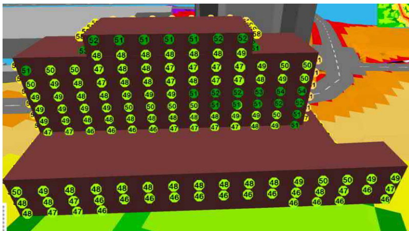
Kuva 5 Päiväajan julkisivumelutasot lännestä, massavaihtoehto B.
