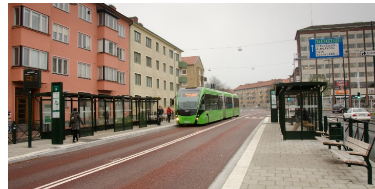
Kuva 7. Superbussien pysäkit sijaitsevat tyypillisesti keskellä katua eikä pysäkkisyvennyksiä ole. Kuvassa Malmön superbussi.
