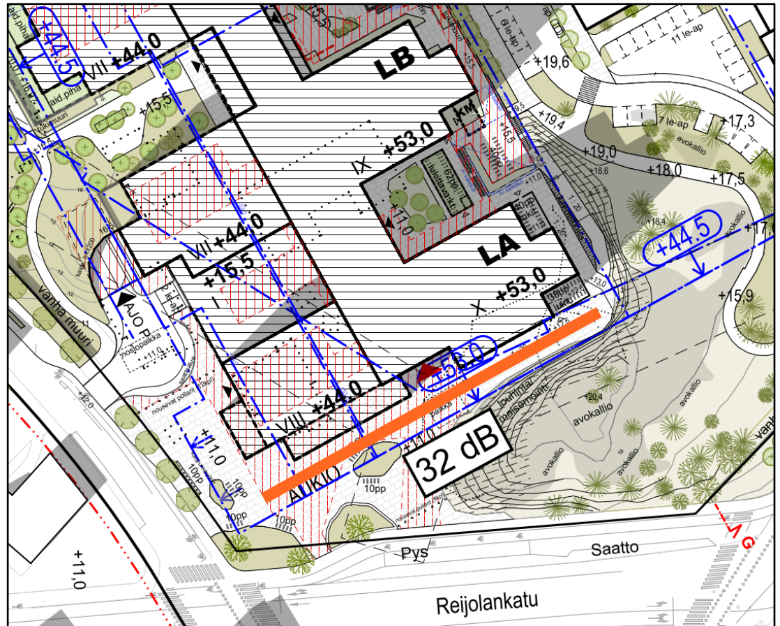
Kuva 2. Päärakennuksen julkisivuille muodostuvat 30 dB ylittävät äänitasoerovaatimukset.
