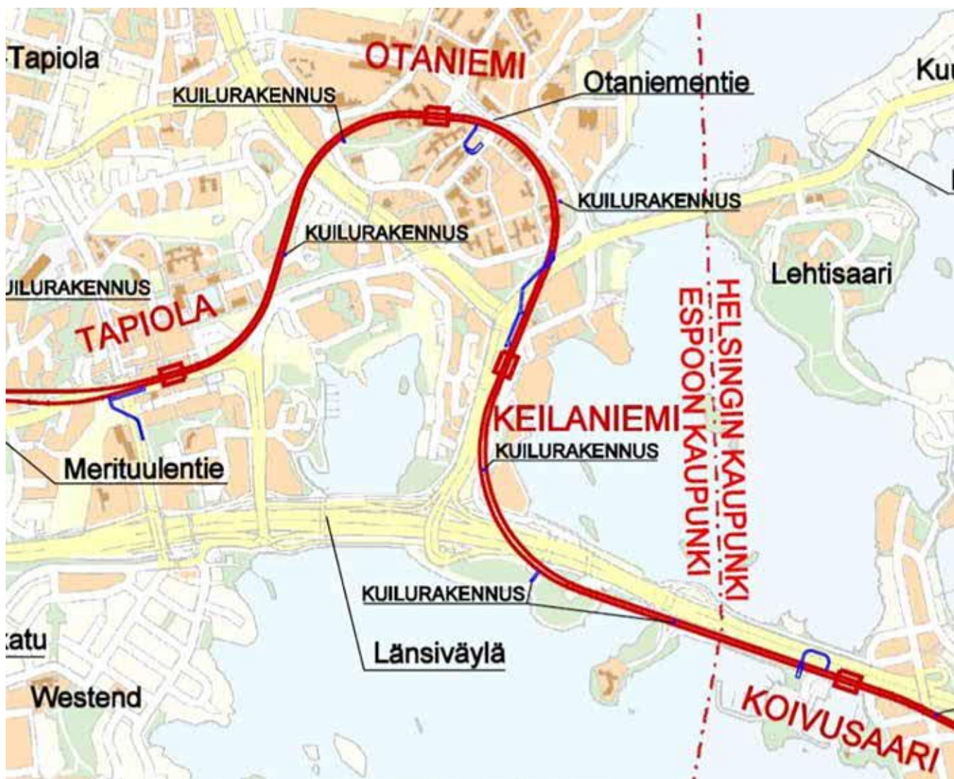
Kuva 4-7. Olemassa olevat Länsimetron huoltotunnelit Tapiola - Koivusaari välillä sinisellä viivalla. Lähde: Länsimetro Oy 2008.
