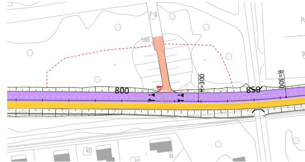
Kuva 49. Kuvassa on esitetty katkoviivalla, miten ramppi voitaisiin harkita haarautettavan kahdeksi reitiksi.
