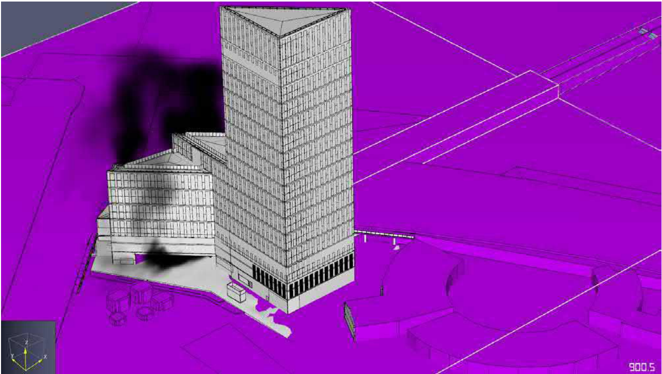
Kuva 35. Ote simulointimallista 15 minuutin kohdalta. Savua purkautuu rakennuksen alta myös liikenneympyrän suuntaan.
