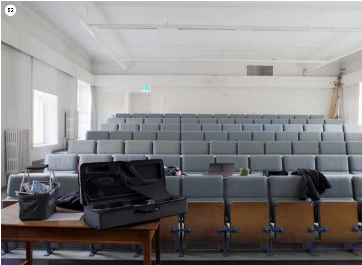
G-siiven ensimmäiseen kerrokseen 1920-luvulla rakennettu luentosali, jossa annettiin psykiatrian alan opetusta. Kiinteät penkit on uusittu 1990-luvulla, alun perin penkkirivien välissä kulki keskikäytävä. 1920-luvun ripapatterit on sijoitettu ikkunoiden väliin umpinaisiin seinän osiin, sillä tilaa ei ole ikkunoiden alla.
