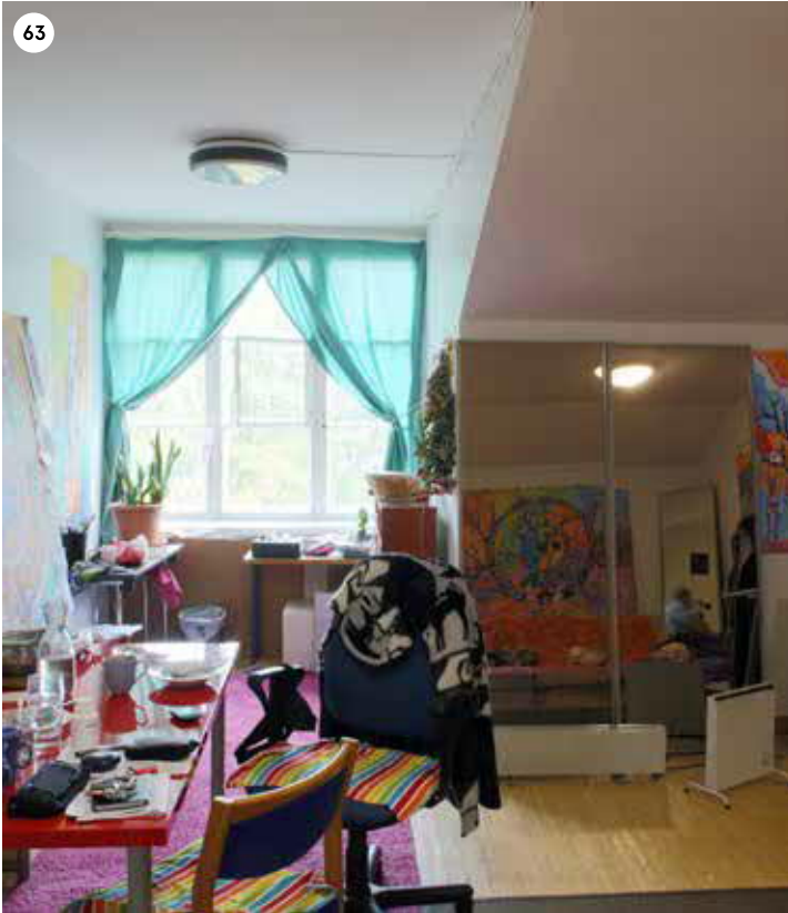
63 Ensimmäiseksi käyttöön otetut kolmannen kerroksen tilat sijaitsevat C-osan pohjoispäässä. Siellä on rinnan kaksi huonetilaa, joista avautuvat ikkunalyhydyssä sijaitsevat suurikokoiset ikkunat kohti pohjoista. Alun perin nämä ikkunat olivat jugendin henkeen pieniruutuiset ja kapeilla välipuitteilla varustetut. Nykytilassa ikkunan keskimmaisessä ruudussa on tuuletusosa.
