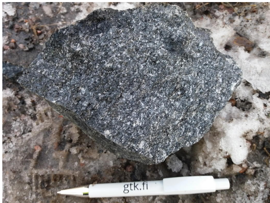
Kuva 37. Dioriittinäyte havainnolta TIN$-2018-004 Niemenmäeltä (P = 6676978 m, I = 25493521 m). Kivi on suuntautunut mutta karkeamman raekoon vuoksi syväkivimäinen. Kynän pituus on 14 cm.
