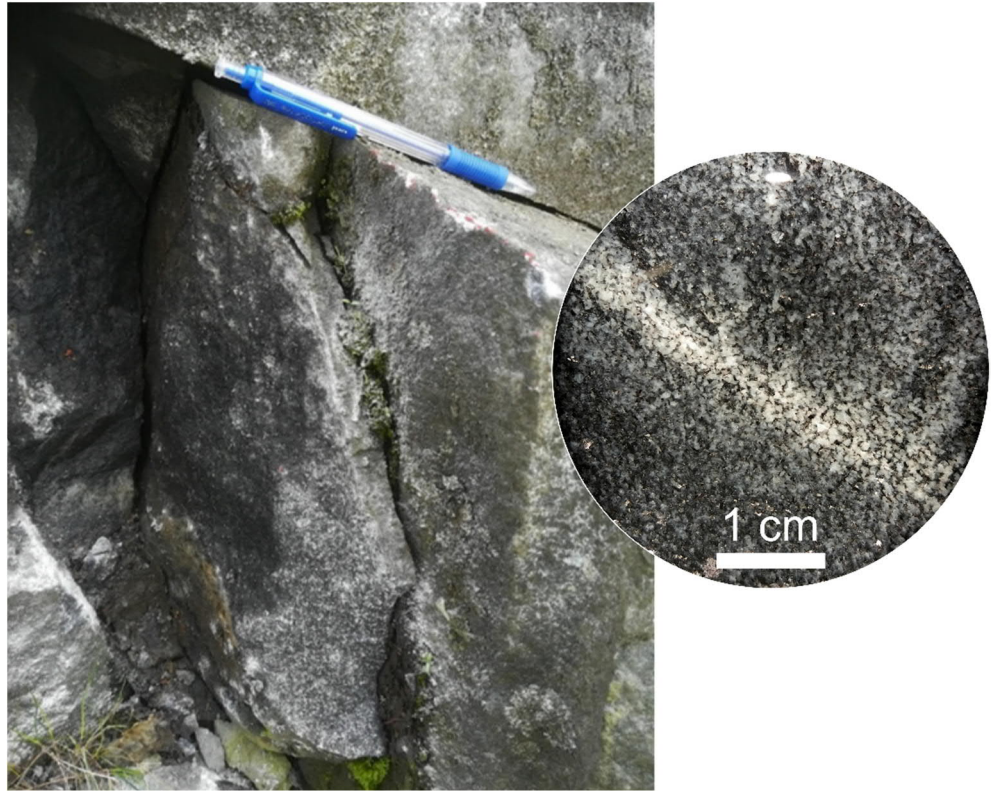
Kuva 51. TIN$-2018-49. Tieleikkaus Kontulassa (P = 6680489 m, I = 25504960 m), biotiitti-plagioklaasigneissi. Uppokuva on m \ddot{a} r \ddot{a} st \ddot{a} n \ddot{a} ytekiekosta.
