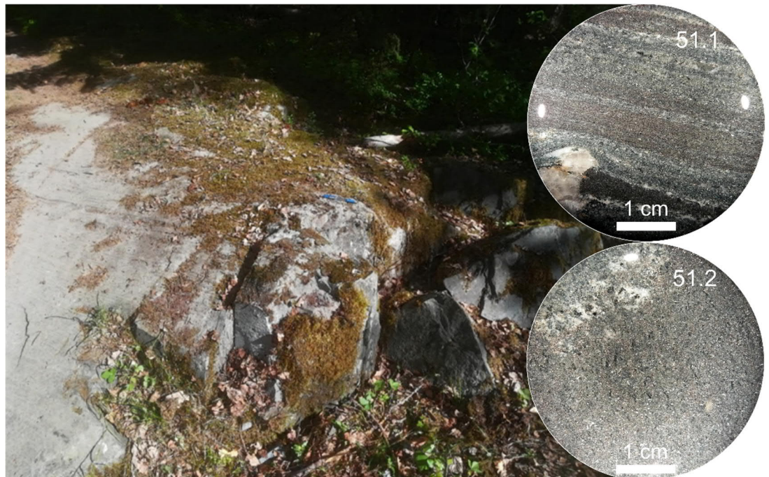
Kuva 52. TIN$-2018-51. Pieni kalliopaljastuma Sundbergissa (P = 6680182 m, I = 25509300 m). N \ddot{a} yte on raitaisesta biotiitti-plagioklaasigneissist \ddot{a} . N \ddot{a} ytteest \ddot{a} tehtiin kaksi n \ddot{a} ytekiekkoa (uppokuvat) kiven termisen anisotropian selvitt \ddot{a} miseksi (kts. liite 1). Uppokuva on m \ddot{a} r \ddot{a} st \ddot{a} n \ddot{a} ytekiekosta. Uppokuvissa valotusta on hieman nostettu, jotta kiven tekstuuri n \ddot{a} kyisi selke \ddot{a} mmin.
