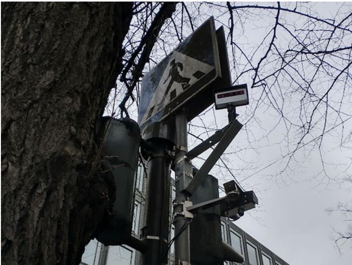
Kuva 2. Delicoden stereokamera asennettuna.
