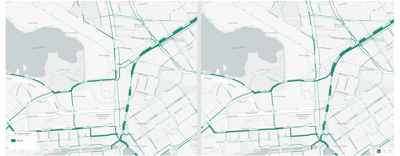
Kuva 61. Pyöräliikenteen kysyntäennuste (KVL) vertailuvaihtoehdoissa (vasen kuva) ja hankevaihtoehdossa (oikea kuva) vuoden 2035 ennustetilanteessa. Ennustetilanne ei sisällä Länsibaanan kokonaisuutta Länsiväylän varressa.
