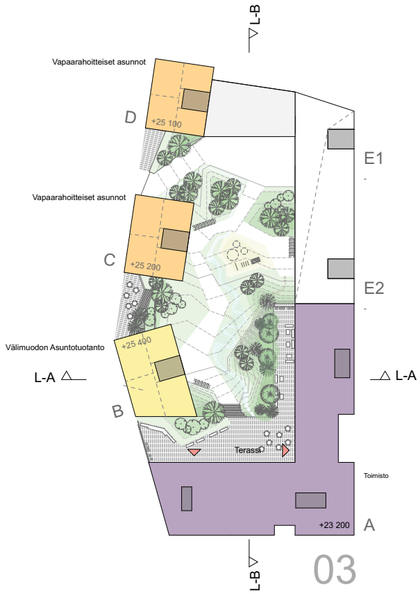
Pysäköintilaitoksen ratkaisuperiaate: pohjapiirros taso +23,2 ja kattokuva
