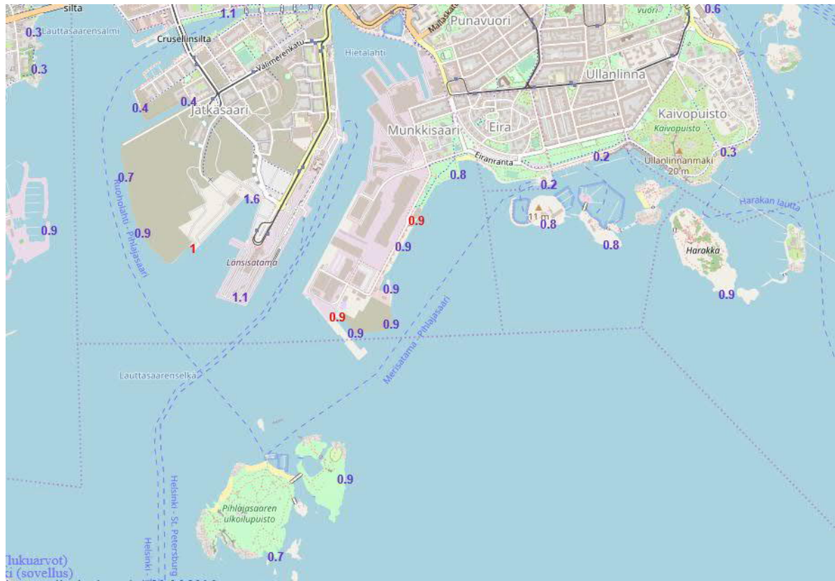
Kuva 3. Arvioidut merkittävien aallonkorkeuden maksimi-arvot eripuolella suunnittelualuetta. Punaisella esitettyjen arvojen pisteissä on tehty aallokkomittauksia ja sinisellä esitetyt pisteet laskennallisia. ( https://www.hel.fi/static/kv/Geo/Vesi/Kartta.html ).
