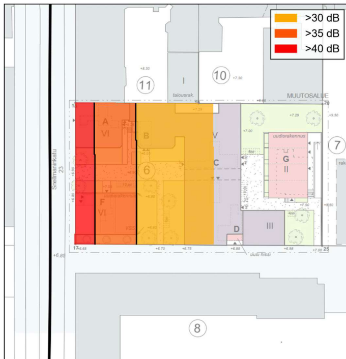
Kuva 4: Runkomelumallinnukseen tulos Snellmaninkadulla kulkevalle raitiotieliikenteelle, esitettynä asemapiirroksessa rakennusten 1. kerroksen osalta. Kuvassa on esitetty alueet, joissa runkomelu ylittää mallinnuksen perusteella 30 dB runkomelutason.
