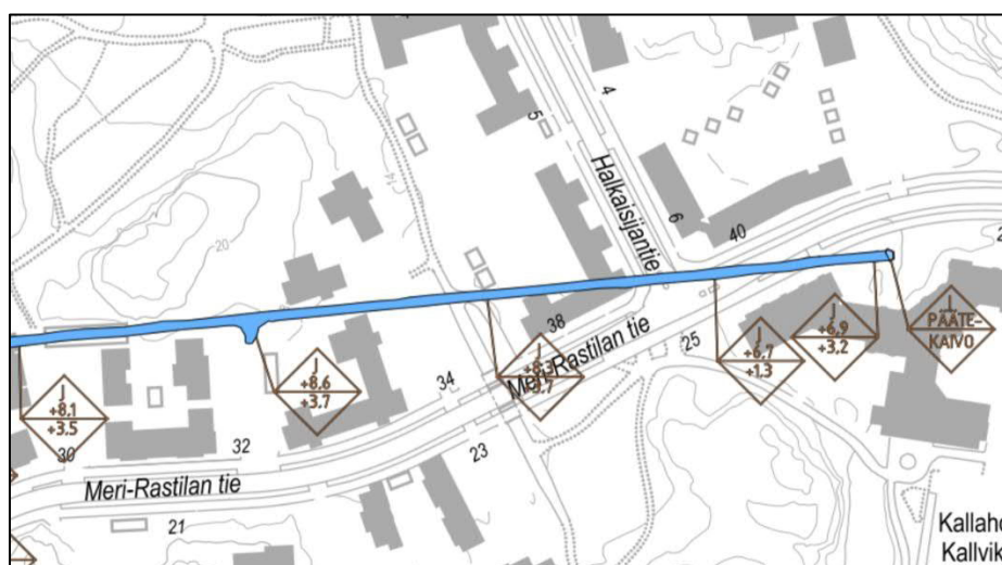
Jätevesitunnelin sijainti ja korkeusasema kaava-alueen keski-osassa.
