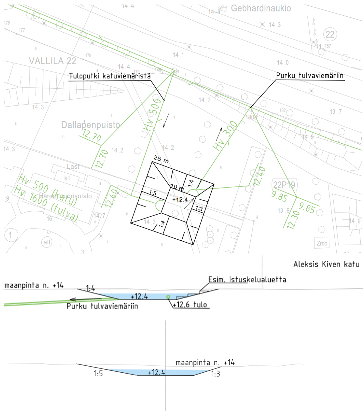
Kuva 10 Hahmotelma Dallapenpuiston hulevesirakenteesta ja sen poikkileikkauksesta. Rakenteeseen tulee 500 tuloputki hulevesiviemäristä ja vedet puretaan 300 putkella tulvaviemäriin. Vesi nousee n. 0,7 m pohjasta kerran kolmessa vuodessa tapahtuvassa rankkasadetilanteessa ja kerran viidessäkymmenessä vuodessa allas on täynnä (vesipinta 1,4 m pohjasta).
