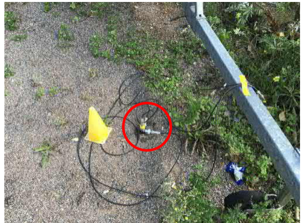
Mittauspiste 10. Sijainti alueen pohjoispäädyn parkkialueella radan puolella. Anturien kiinnitys maaruuvilla.
