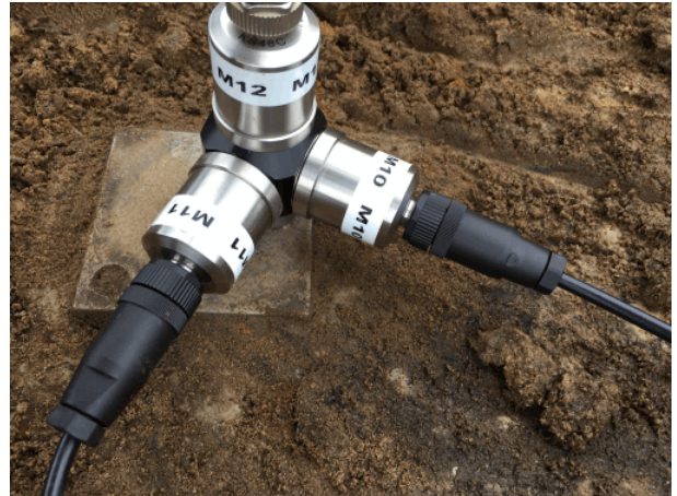
Mittauspisteet 6 ja 7. Sijainti purkutyömaan tontin keskiosassa. Anturien kiinnitys maaruuvilla.
