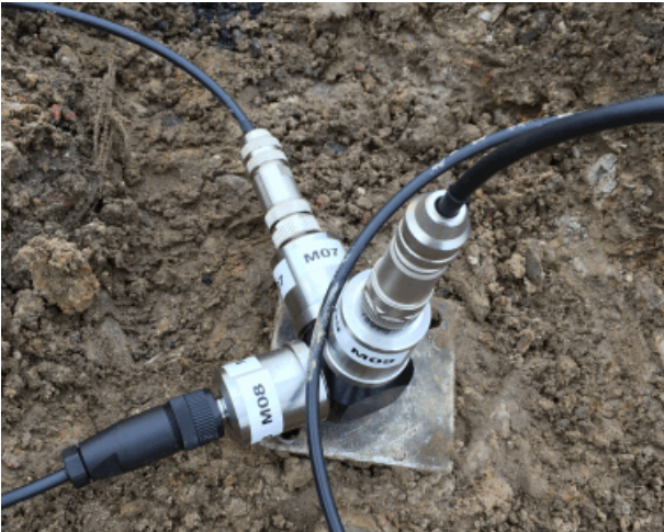
Mittauspisteet 6 ja 7. Anturien kiinnitys maaruuvilla.
