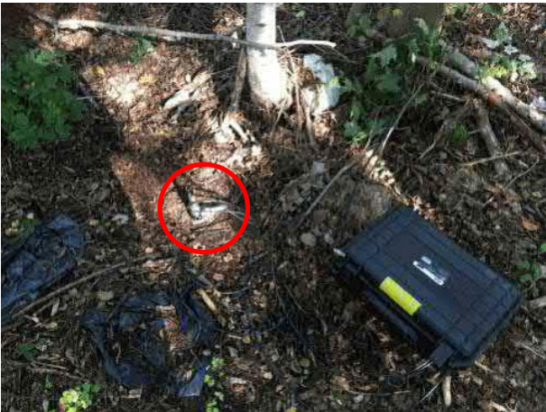
Mittauspiste 3. Sijainti metsikössä kadun puolella. Anturien kiinnitys maaruuvilla.
