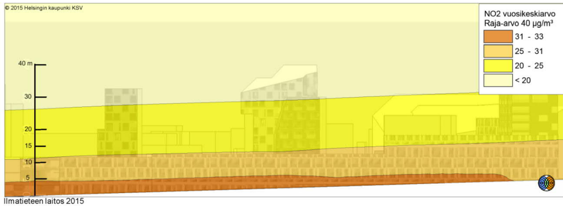
Kuva G. Typpidioksidin (NO 2 ) vuosiraja-arvoon verrannolliset pitoisuudet Veturitien julkisivulla 3. Taustalla näkyviä rakennusmassoja ei ole huomioitu mallinnuksessa kuvassa näkyvällä tarkkuudella.
