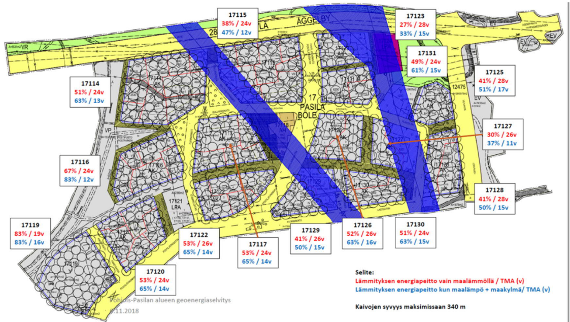
Kuva 5. Energiaperitto, kun kaikki Pohjoisen Postipuiston korttelit hyödyntävät maalämpöä. Punaisella merkitty luku ilmaisee energiaperiton, kun käytössä on vain maalämpö. Sinisellä luvulla on puolestaan merkitty energiaperittoa silloin, kun käytössä on sekä maalämpö että jäähdytys. TMA on energiajärjestelmän takaisinmaksuaika vuosissa. Laskenta tehtiin COMSOL Multiphysics® v5.3 –ohjelmistolla ja mitoitusaikana on käytetty 40 vuotta. [5]
