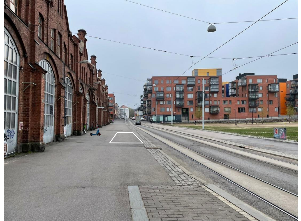
Kuormauspaikan sijainti Traverssikujalla, kuva nykyisen ratikkapysäkin suunnalta. Kuormauspaikan ja pysäkin väliin jätetään 12,6 m, jotta huoltoajoneuvojen poistuminen alueelta on turvallista. Myös jalkakäytävällä sijaitseva kaivo on otettu huomio.
