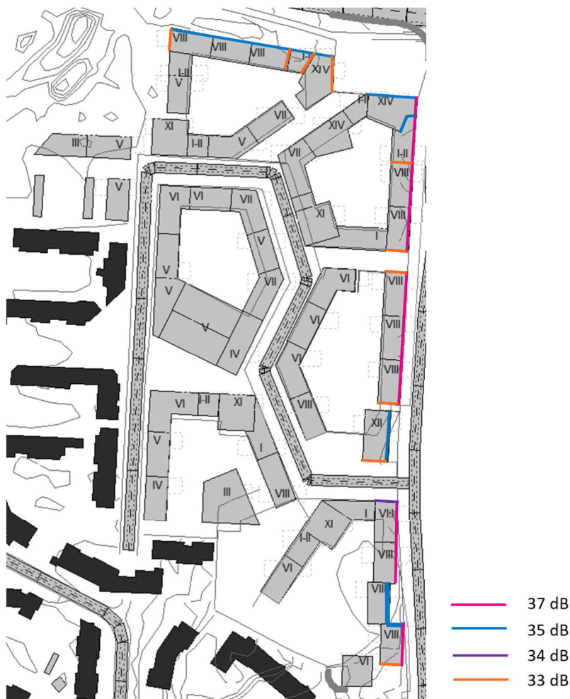
Kuva 7. Julkisivuille suositeltavat äänitasoerovaatimukset
