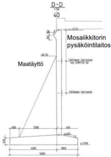
Kuva 19. vaihe 1 runko ja koillispäädyn betoniseinän takana olevan siipimuuri.
