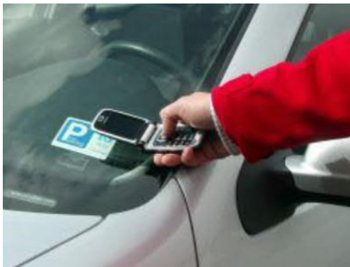
Kuva 18 RFiD-tunninte pysäköintitunnuksessa ( http://www.toptunniste.fi/index.php?id=rfid-parking )
