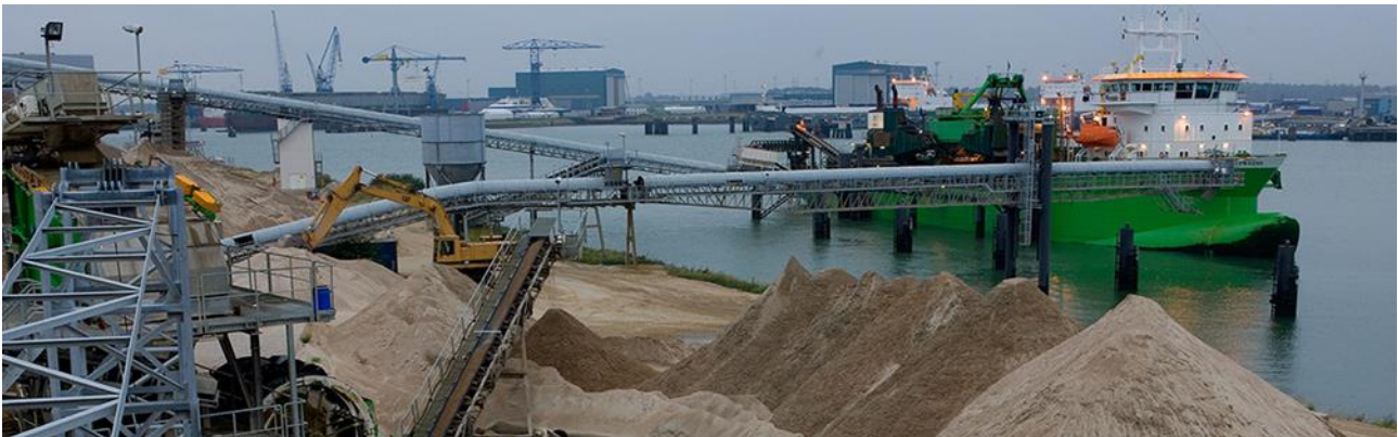
Kuva 28. Merihiekan kuivapurku imuruoppaajalta Vlissingen-Oost:ssa Hollannissa. kuva: https://www.demegroup.com/expertises/processing-sand-gravel
